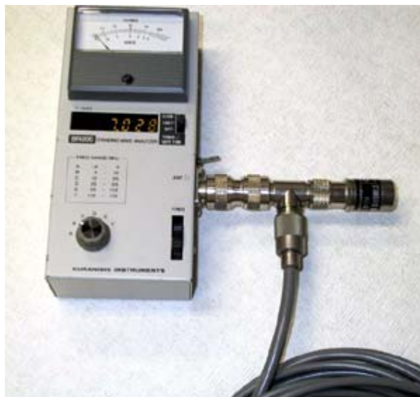
Fig.3 インピーダンスメータを用いて調整
