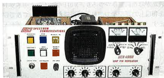
▲1980年代にアメリカのメーカーで製作された430MHz帯レピータ装置の例。システムの内容が非常にわかりやすい構造になっています。
