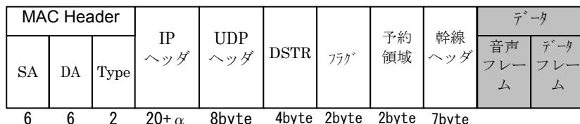
推奨 音声ヘッダのパケットロスが発生することを考慮して、音声データ 21 回毎に（再同期信号が挿入されている音声データの直前に）音声ヘッダを挿入すること。但し、音声データの送信間隔は 20 ミリ秒を維持すること。また、受け取り側で既に音声ヘッダを受け取っている場合は、以後の音声ヘッダは破棄すること。（次期バージョンで正式採用の予定）
