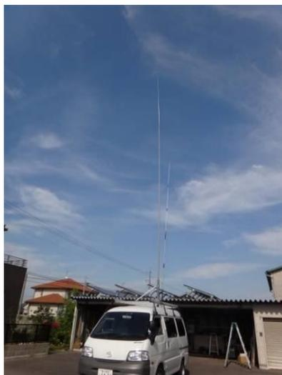
運用時には塩ビ管を起こし、塩ビ管の中に収納した釣り竿を伸ばす方法を取った。しかし折りたたみ棚受け金具は通常、下から起こして水平にするための金具なので、水平から垂直にすると折りたたみ棚受け金具が元に戻ろうと倒れるので、折りたたみ金具の折り曲がり部に5mmのボルトを蝶ネジで止めて倒れないようにした。また塩ビ管が横揺れするので横揺れ防止に補強用の金具を90°の位置に取り付けた。(写真参照)
