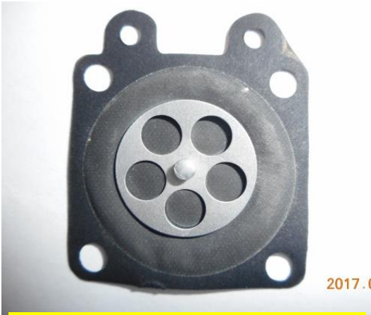
大きさ約3cmの取り外したダイヤフラム
