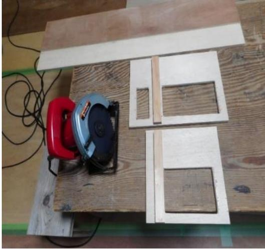
その向こう側が切り込み時に丸鋸を載せる場所が確保される改良型。定規をあてがい、丸鋸を載せるとその目方で手前が持ち上がる欠点もあるが前方を押えて使えばまずまずの成果で自己満足しました。さらに向こう側は長尺用です。工夫を加えて改良型定規はちょっと大きくなるが直角のストッパーになる裏の木を少し前に寄せて加工材料に回転刃が当たる前に丸鋸本体が切り込み方向に向いて乗っており回転刃が直角に入っていきます。左の写真の位置では中央付近の回転刃の右下にあるストッパー兼直角を出す小さな角材は加工材料に当たっているが丸鋸
