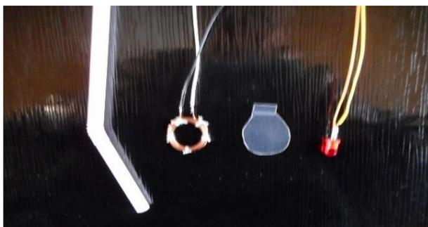
最初は元年の夏に0.4mmのポリウレタン銅線10M巻き1セットで1個、1個コイルを巻き5個の試作コイルを作った。考案者の残したパーツと組み合わせて電線をはんだしてストロー、LEDなどをグルーガンで固めてセンサー部をつくった。作動する金属探知機と作ったセンサーを取り替えながら実験、そのすべてが作動した。令和元年秋でした。この時これは見よう見まねで同じものをたくさん作れば電波教室がやれそうだと感触を得た。コイル材料を追加購入してコイル巻き作業、それからいよいよやる気になってプラスチックのシール容器を75個購入。友人から卓上ボール盤を借りてきて、箱一
