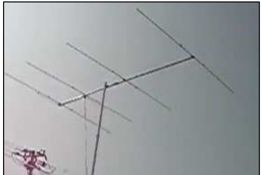
（写真）三浦市宮川公園から上海局を迎撃 ／迎撃に使用した 50MHz 4Ele HB9CV
