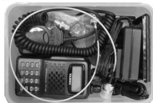
乾電池運用できるFT-80とスピーカーマイク 10年保存乾電池を専用ケース内に保管
