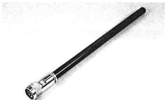
《写真5》保護パイプを取りつけて完成した5.6GHz帯コリニア・アンテナ
