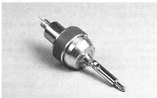
《写真3》完成したシュベルトップ部にコネクタのセンターピンを取りつける
