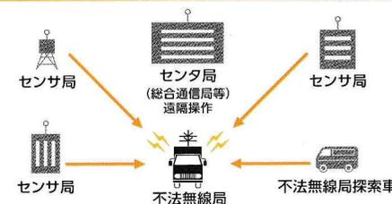
不法な電波などを取り締まるため総務省が電波監視システム「DEURAS(デュラス)」を整備・活用しています。全国に設置されたセンサ局や不法無線局探索車で、不法電波の発射源を探し出します。
